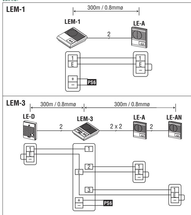
★ 不可拆除非機上的短路連接。 PS6 :PS-0602D、PS-0602C
